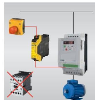
La funzione di sicurezza integrata STO (Safe Torque Off) elimina la necessità di utilizzare un contattore di rete.
