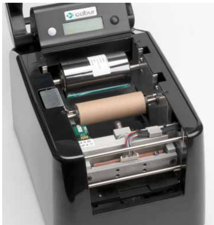
Inserimento del nastro sul supporto posteriore
