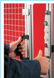
Sistema di sicurezza con solenoide di sblocco e pulsante di richiesta accesso e di reset.
