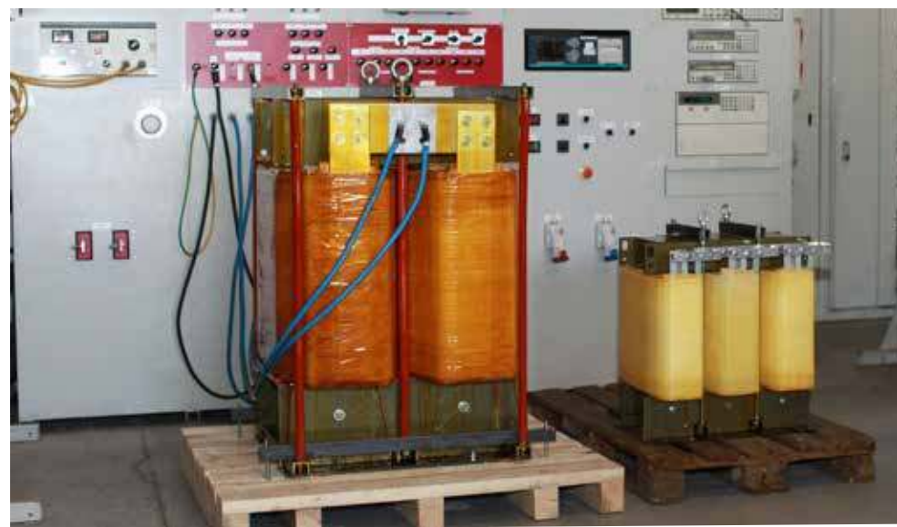
Reattanza trifase 3800A per raddrizzatore 6-PULSE. Peso 2000kg
